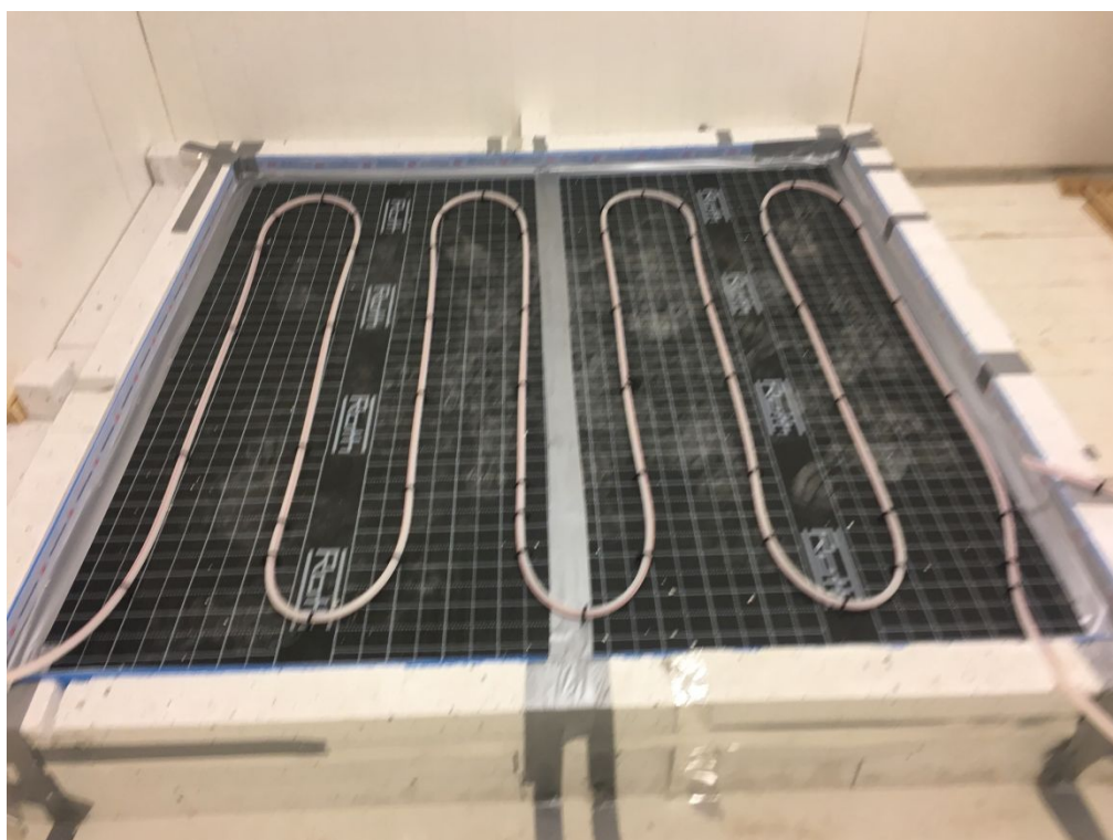
Foto 14: Prøveobjekt med senteravstand 250 mm
