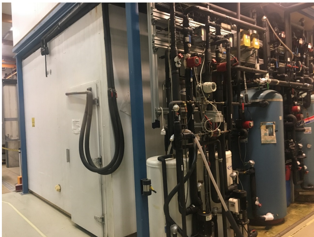
Foto 1: Energilaboratoriet for gulvvarme med deler av varme-/kjøleanlegget
