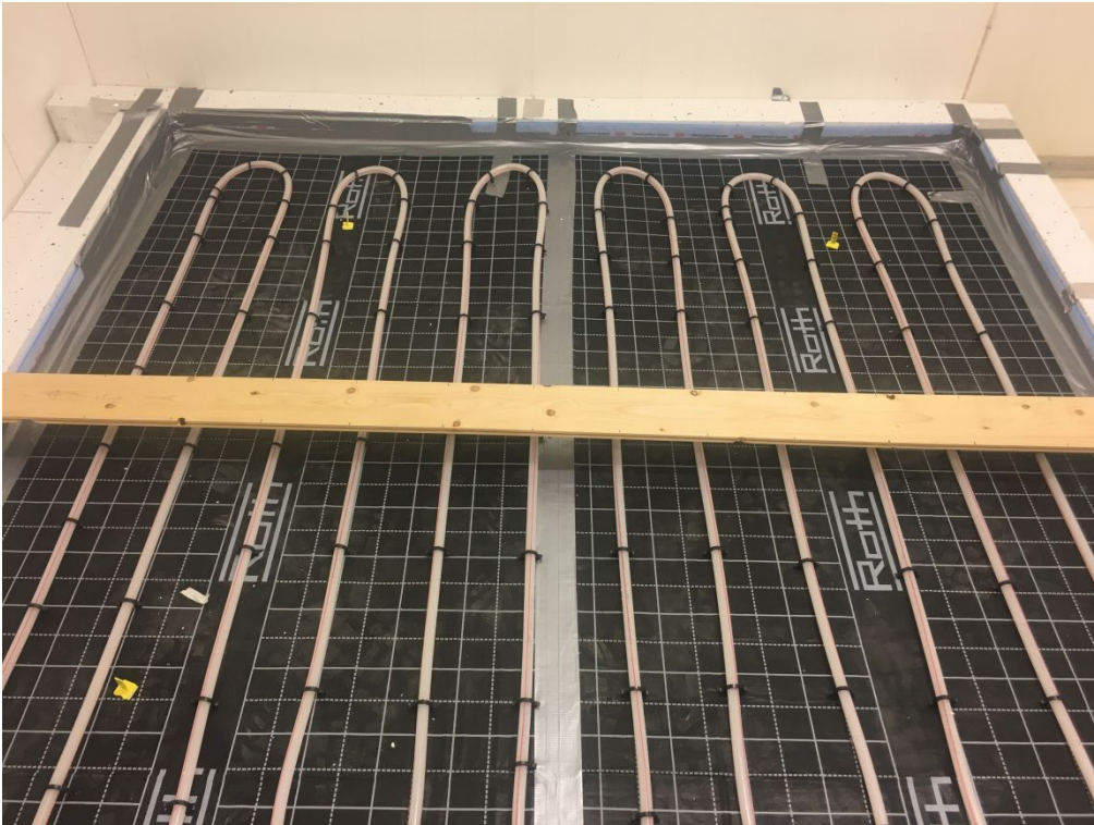
Foto 7: Prøveobjekt med senteravstand 150 mm
