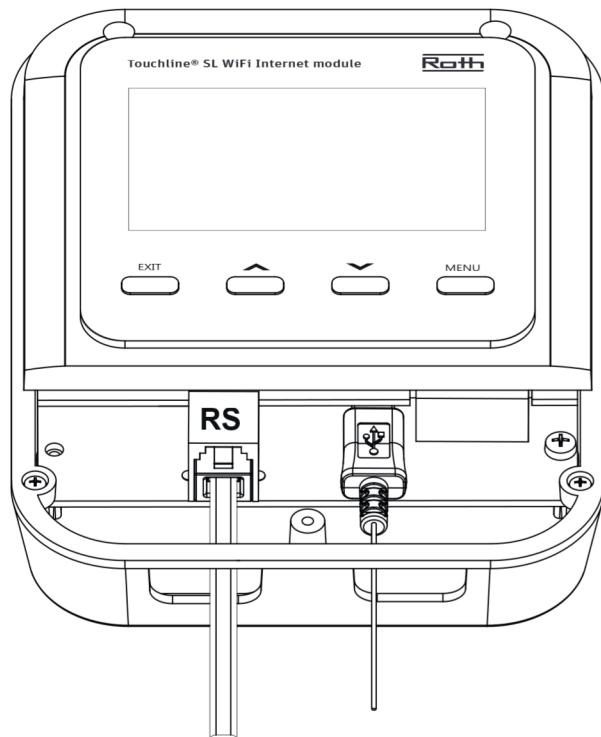
Diagram for ledninger og kommunikasjon med Roth Touchline® SL kontrollenhett 8:
