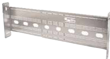
Roth fleksibel skinne til Roth QuickBox Roth fleksibel skinne kan brukes i alle typer av platevegger, både til tre/stålstender og til påføring av vegg fra 2" (48 mm) lekter. Den fleksible skinnen er tilpasset sammen med avløpsboks og flere veggbokser på markedet, skinnen kan justeres fra 330 - 600 mm. NRF nr. 511 82 18
