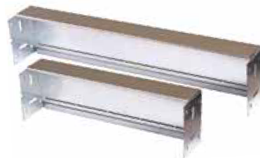
Roth fleksibel skinne til Roth QuickBox De fleksible skinnene kan fås i 2 størrelser, justerbar fra 220 - 400 mm eller justerbar fra 330 - 600 mm. N RF nr. 511 82 21 og 511 82 22.
