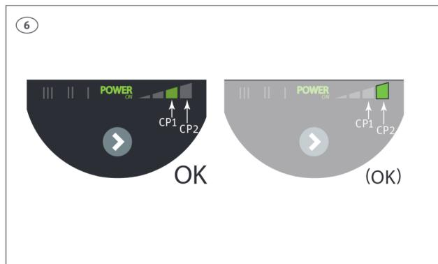
**(DK)** Fejl, som kan hindre pumpens drift (fx blokering), vises ved, at der kun er lys i "POWER ON"-lysfeltet.
